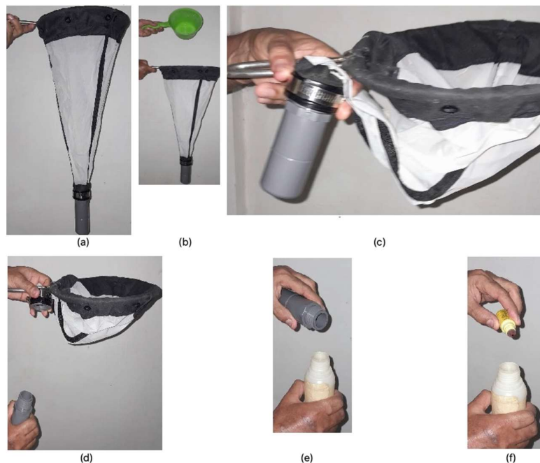
Gambar 11. Prosedur pengambilan dan penanganan contoh air plankton, menyiapkan plankton net (a), contoh air plankton disaring, (c) melepaskan bucket (c), bucket terlepas (d), tuangkan contoh air plankton dari bucket ke botol sampel (e) dan teteskan bahan pengawet ke botol sampel (f).
