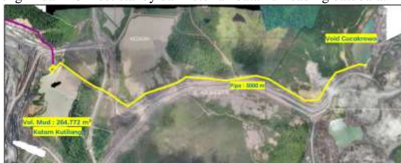
Gambar 2. Perencanaan Pipeline (Sumber : Dokumentasi Pribadi)
