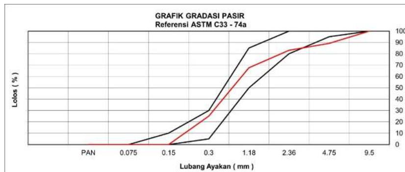
Gambar 3. Grafik Gradasi Pasir Berdasarkan ASTM C33 – 74a
