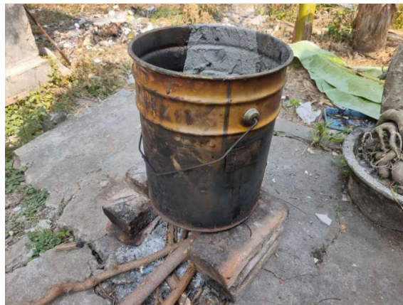
Gambar 3. Tungku Pembakaran dan Drum Pemanas dari ember seng bekas
