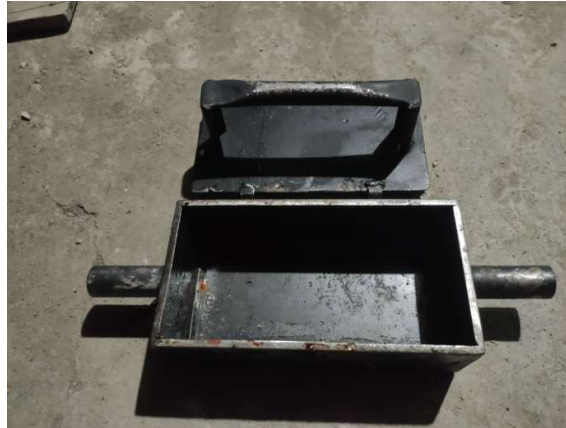
Gambar 4. Cetakan paving block
