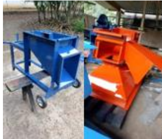
Gambar 14. Proses Finishing (Pelapisan Cat)
