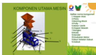
Gambar 8. Rancangan Assy Mesin Pencacah
