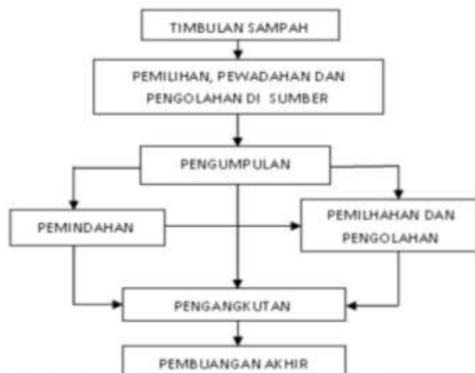
Gambar 6. Diagram Teknik Operasional Pengelolaan Persampahan Sumber: Elamin et al., 2018
