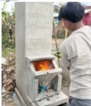
Gambar 3. Proses uji coba pembakaran sampah menggunakan rocket stove
