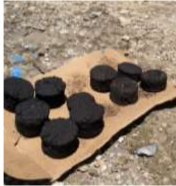
Gambar 6. Proses pengeringan briket
