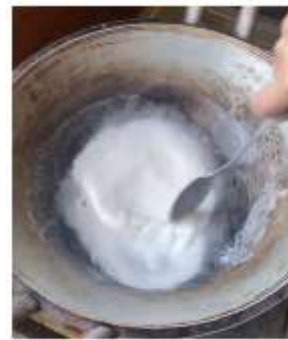
Gambar 4b. Pematangan tepung tapioka menggunakan api sedang untuk meningkatkan daya lekat
