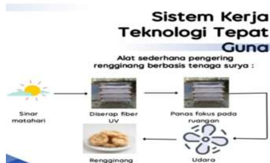
Gambar 1. Ilustrasi alat pengering rengginang berbasis tenaga surya
