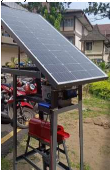
Gambar 1. Alat Pemipil Jagung Tenaga Surya
