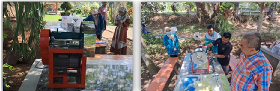
Gambar 2. Mesin pengiris gadung yang diterapkan sebagai teknologi tepat guna di UD “Gadung Badean”
