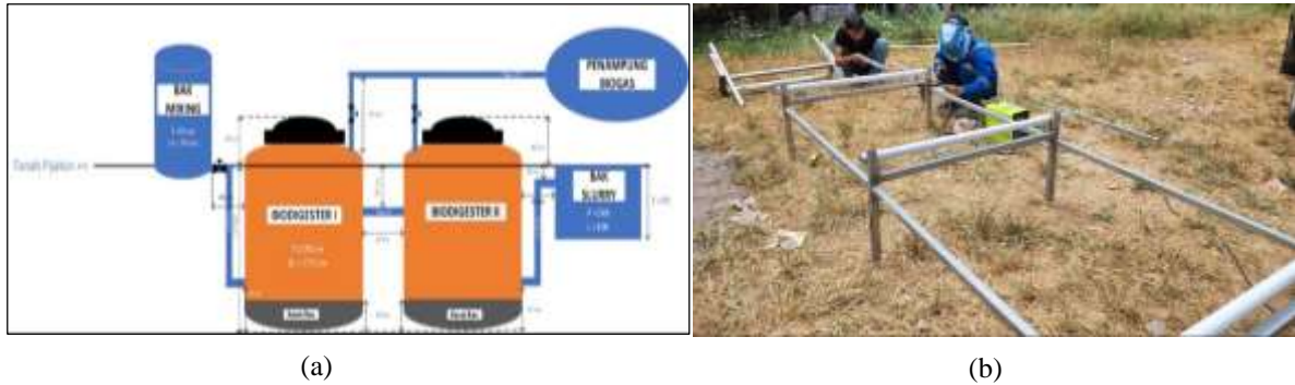
Gambar 4. (a) Desain Pemasangan Biodigester Kotoran Ayam, (b) Instalasi pemasangan Belt Conveyor
