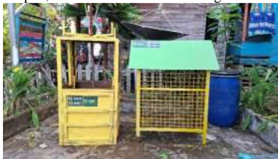
Gambar 4. Mesin Press dan Penampung Botol Plastik
