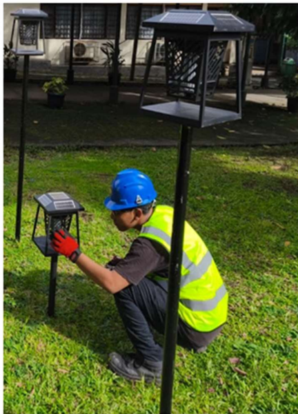
Gambar 3. Perangkat UV berbasis tenaga surya untuk pengendalian hama
