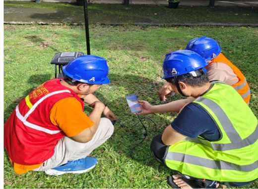
Gambar 2. Sensor tanah 8-in-1 untuk monitoring pH, kelembaban, suhu, EC, dan NPK
