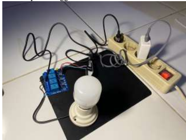
Gambar 1. Foto Keseluruhan Perangkat Sistem Lampu Otomatis Berbasis IoT
