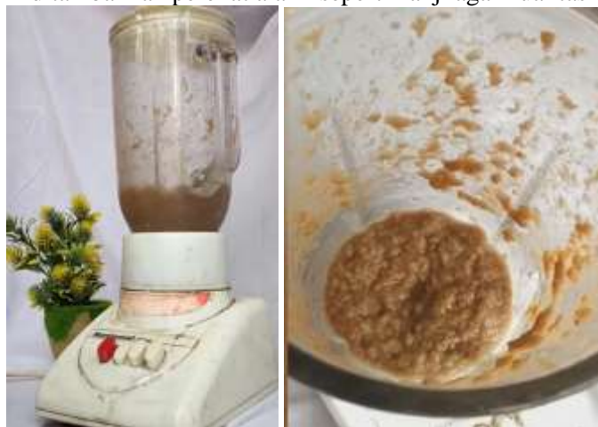
Gambar 5. menghaluskan pulp dengan blender
