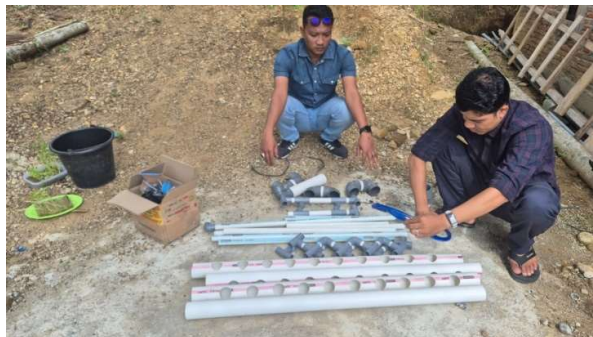
Gambar 2. Praktik pemotongan, pelubangan, dan perakitan komponen pipa PVC untuk modul hidroponik vertikal skala pekarangan secara partisipatif.
