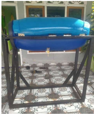
Gambar 3. Komposter Manual Berbasis Drum Plastik yang Telah Selesai Dibuat
