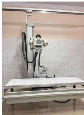
Gambar 1. Pesawat sinar-X di Laboratorium Universitas Senior Medan (1. Tabung sinar-X; 2. Shutter collimator; 3. Meja pemeriksaan)
